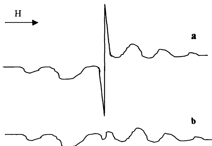
Figura 2.5. Spectrul RES al unei polietilene de înaltă densitate, nestabilizată, iradiată \gamma la 77 K. (a) imediat după terminarea iradierii; (b) după trei zile de la încetarea acțiunii radiațiilor.
